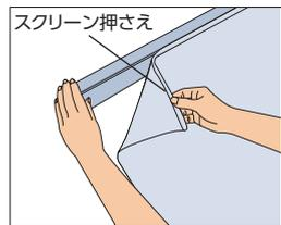
生地とスクリーン押さえを巻取りパイプの端からはがして生地を取外してください。
